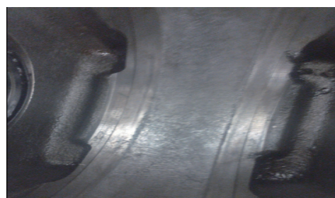
图4 磨损的轴承座
